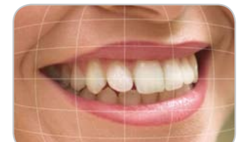
Standardkamera: tonnenförmige Verzeichnung
