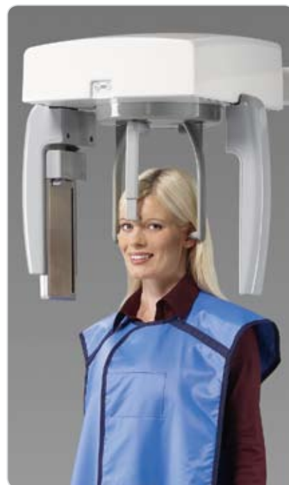
Soporte de cabeza cefalométrico de CRANEX® D en la posición lateral.
